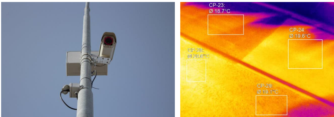
Abbildung 8: Montage Infrarotkamera und Blickwinkel Infrarotbild der TIM 40 Kamera
