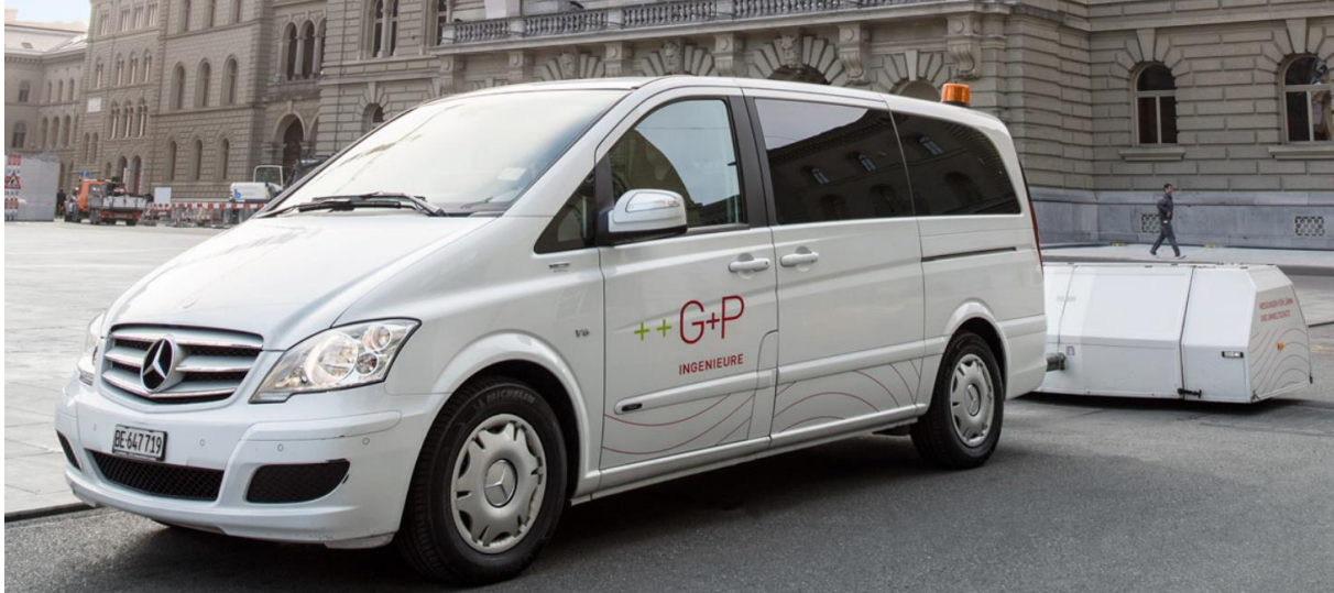
Abbildung 12: CPX Messfahrzeug mit Anhänger zur direkten Messung der Reifen-Fahrbahngeräusche
