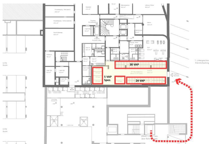
Abbildung 28: Veloraum in 1. UG mit Zugang zum Veloraum via Lift, Ausschnitt aus Plan Richtprojekt
