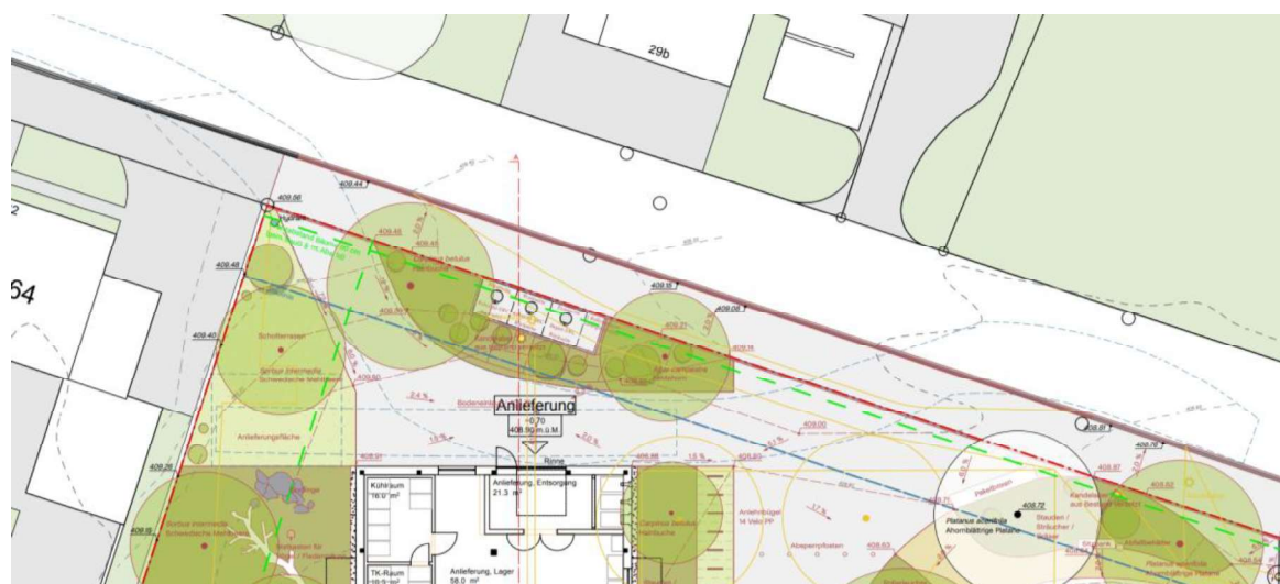
Abbildung 29: Schleppkurvenprüfung Anlieferung Baubereich A (Quelle: BÖE studio, 2025)
