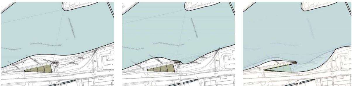
Abb. 6: Ueberschwemmungsbereiche bzw. Uferlinien bei NW, MW und HQ 100 (s. Bauprojekt in der Aktenaufgabe)
