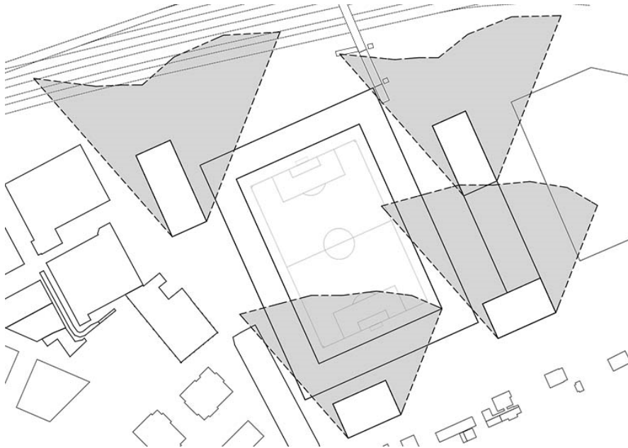
Darstellung des Zweistunden-Dauerschattens am mittleren Wintertag (8. Februar und 3. November) Grundlage ist das konsolidierte Richtprojekt.
