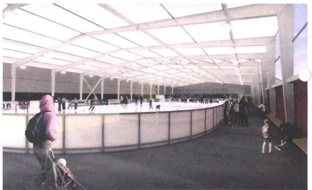
Visualisierung: Ausseneisfeld wird durch transluzente Folie vor Sonne und Regen geschützt.
