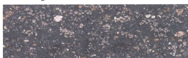
Beton anthrazit eingefärbt mit Einstreuung von farbigen Natursteinkörnern
